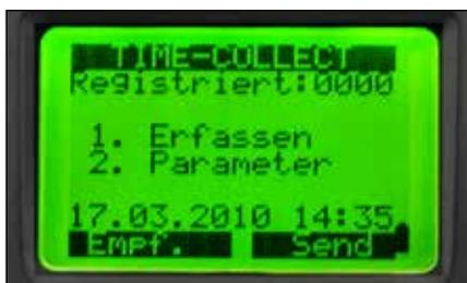
Im Hauptmenü kann mit der linken blauen Taste der Stammdaten-Empfang und mit der rechten blauen Taste das Senden ausgelöst werden. Mit der Taste 1 wird das Erfassen gestartet.
