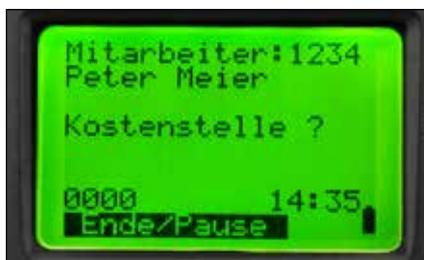
Jeder Mitarbeiter hat sein eigenes Gerät. Mittels eines Barcodes kann das Gerät einem anderen Mitarbeiter zugeordnet werden. Auch Kostenstellen-Barcodes werden akzeptiert.
