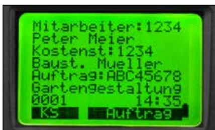
Nach der Auftragserfassung werden die Daten inkl. dem Zeitstempel abgespeichert und der Zähler unten links um 1 erhöht. Es kann zur Kostenstellen- oder Auftrags-Erfassung geschritten werden.
