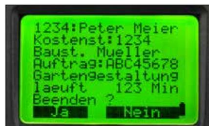
Nach dem Auslösen von Ende/Pause kann an diesem Bild erkannt werden, wie lange der aktuelle Auftrag schon läuft. Die Beenden-Frage kann beantwortet werden.
